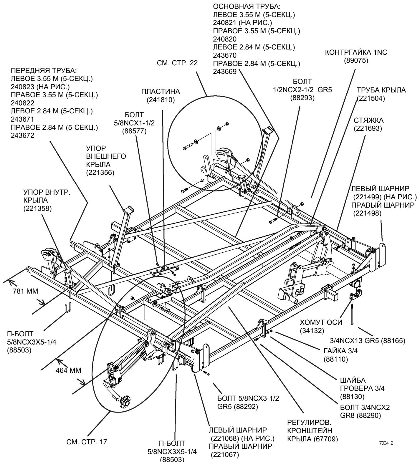
ПРИМЕЧАНИЕ: МЕСТОПОЛОЖЕНИЕ УПОРОВ КРЫЛЬЕВ ПРИБЛИЗИТЕЛЬНО. БУДЬТЕ ОЧЕНЬ ОСТОРОЖНЫ ВО ВРЕМЯ ПЕРВОГО СКЛАДЫВАНИЯ КРЫЛЬЕВ. ВАМ МОЖЕТ ПОНадобиться отрегулировать положение упоров крыльев.
