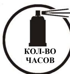
Примечание: Обрабатывайте графитовой аэрозольной смазкой с интервалом в часах, указанным на символе.
